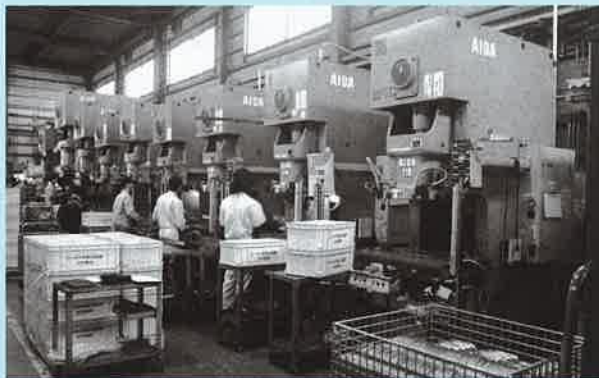
▲ 80トン~250トン9台タンデム
